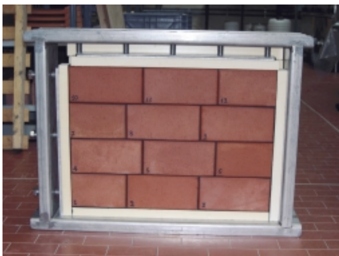
Assemblaggio di elementi in laterizio per pavimentazione da sottoporre a test di resistenza al gelo secondo la norma UNI EN 1344. Il materiale bianco è un isolante in polistirolo mentre i giunti sono costituiti da strati di gomma con caratteristiche definite dalla norma stessa.
