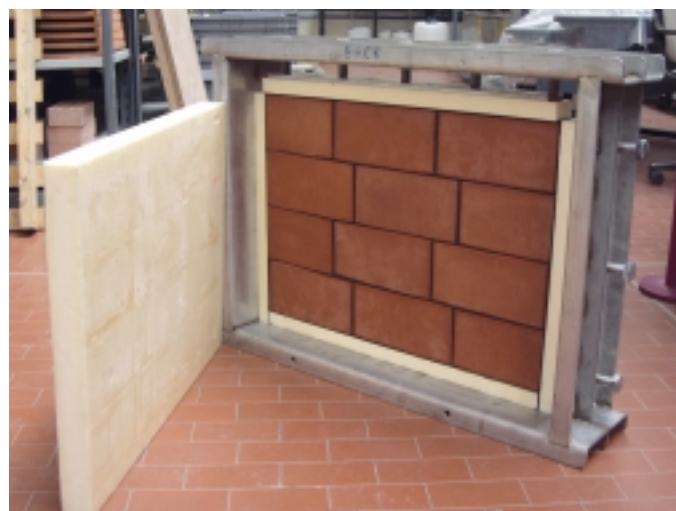
Pannello assemblato con elementi in laterizio per pavimentazione da sottoporre a test di resistenza al gelo secondo la norma UNI EN 1344. La superficie esposta è quella che viene sottoposta direttamente ai cicli di gelo/disgelo e corrisponde alla superficie in opera.
